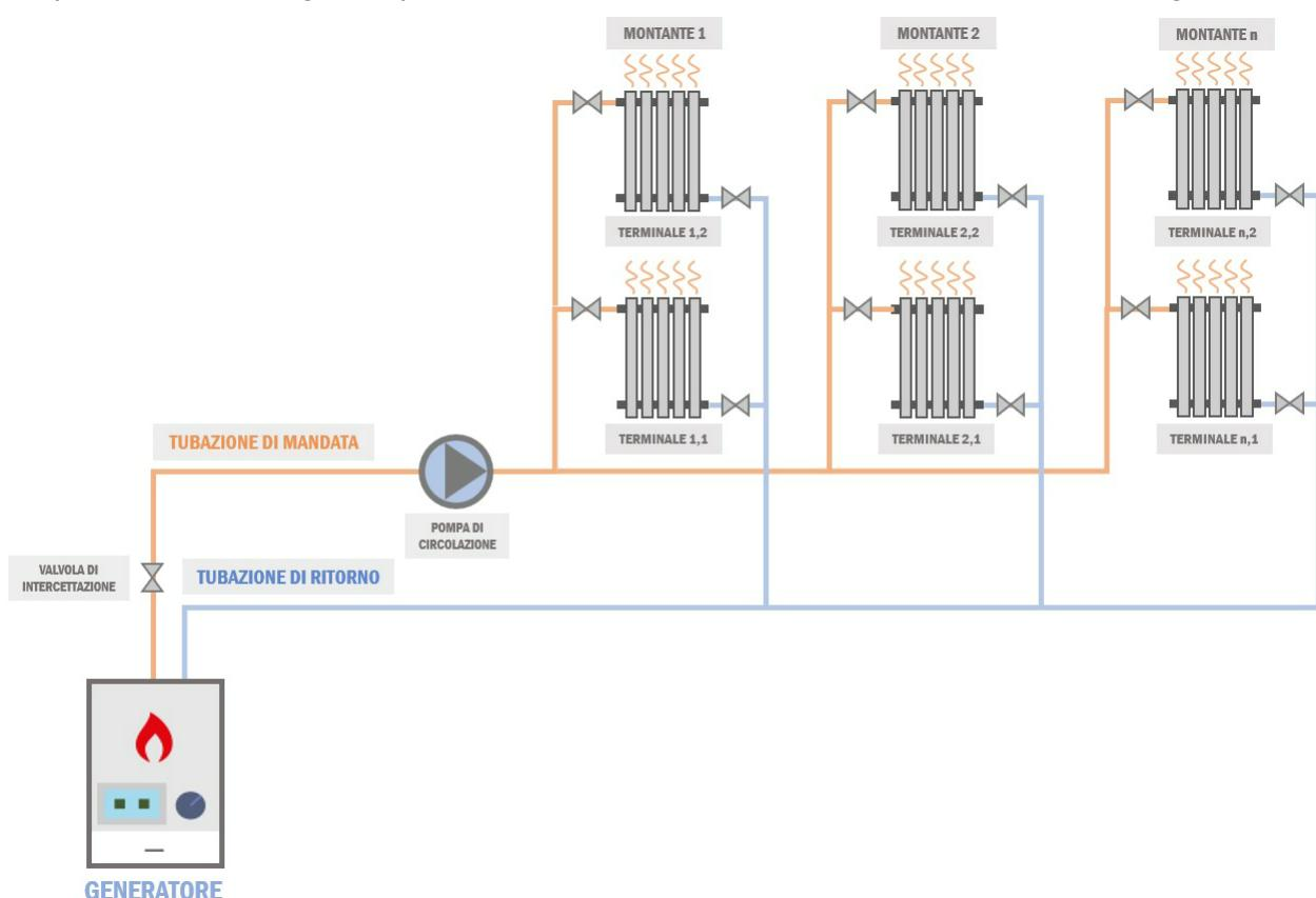
Questa soluzione è impiegata particolarmente per impianti centralizzati, in cui il generatore è posto al piano terra o seminterrato, così come l'annessa rete principale di tubazioni di mandata e di ritorno. Da questa si ergono poi delle montanti verticali che sezionano verticalmente l'edificio ed alimentano i corpi scaldanti dei vari piani (appartamenti).
